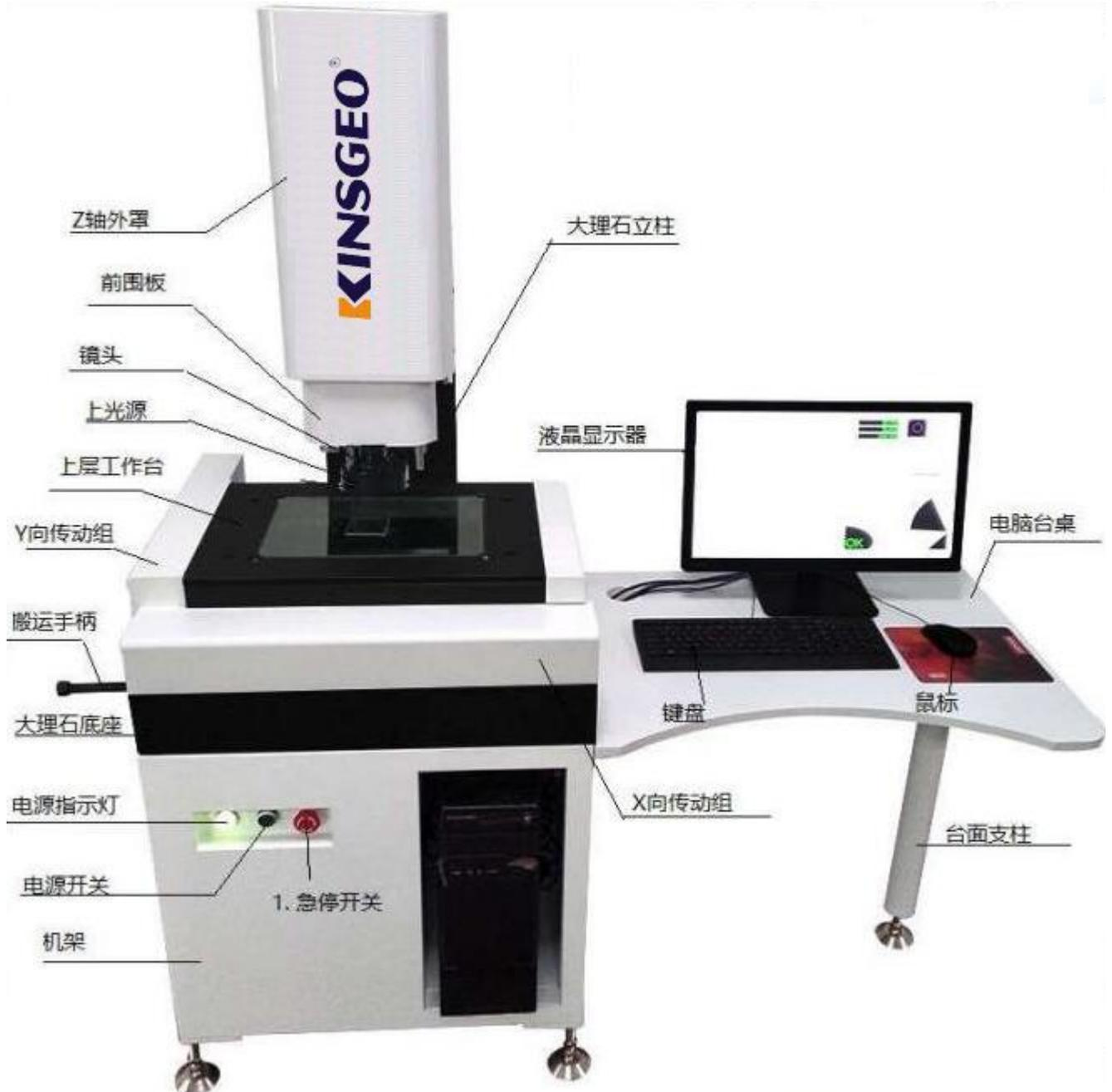
2.2.1 影像式测量仪主要有支撑部分、视频部分、工作台部分及照明部分。
