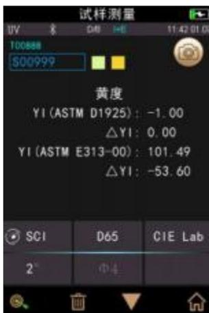
图38 试样测量界面下的黄度指数界面
